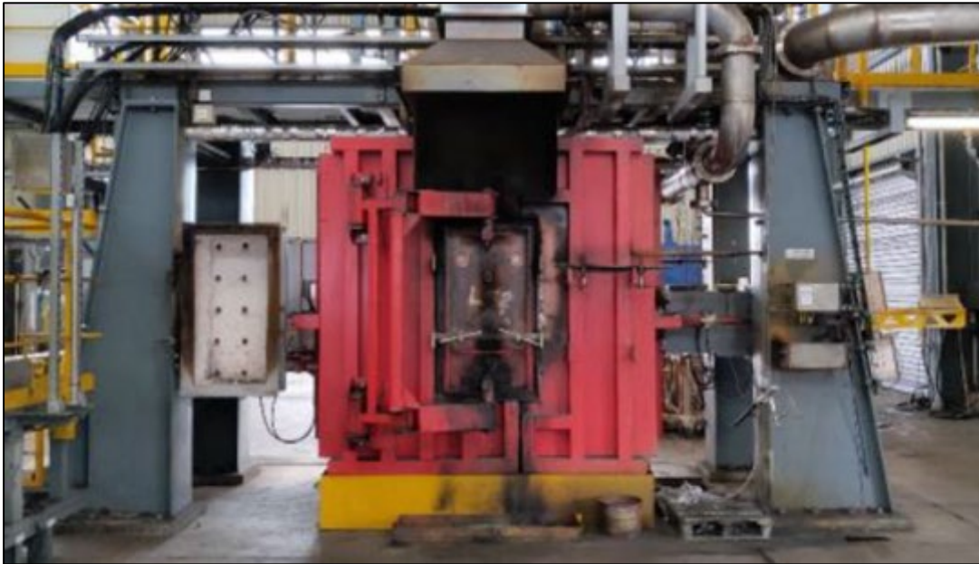
Poloprovozní pec s pohyblivou stěnou
